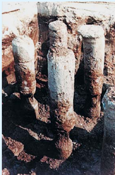
Рисунок 1. Типичные дефекты буронабивных свай
