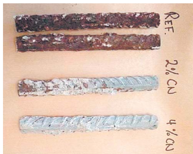
Железная арматура, подвергнутая действию хлоридов, извлеченная из двух бетонных цилиндров без добавок (сверху), цилиндра с добавлением 2% \text{Ca}(\text{NO}_3)_2 (в середине) и цилиндра с добавлением 4% \text{Ca}(\text{NO}_3)_2 (снизу), после хранения в течение 4 лет при температуре 38° С и относительной влажности 90%.
