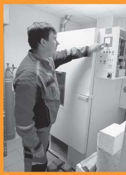
Определение концентрации выделения вредных веществ из образцов бетона в климатической камере CM 10/40-1000 сФ
