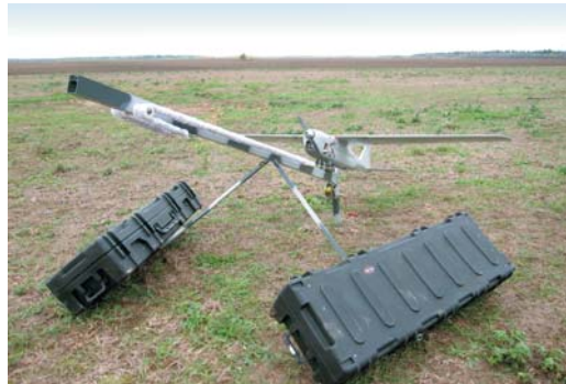
Аэрофотосъемочный комплекс на базе БПЛА «Орлан-10» в собранном и разобранном виде
