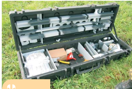
Аэрофотосъемочный комплекс на базе БПЛА «Орлан-10» в собранном и разобранном виде
