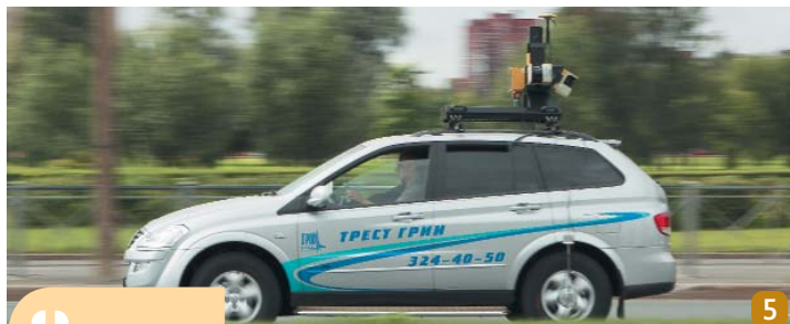
5) Система мобильного лазерного сканирования Торсон IP-S2. 6) Выполнение комплекса геодезических работ по наблюдению за деформациями прибрежной полосы в заливе Петра Великого на Дальнем Востоке. 7) Выполнение работ по обследованию геодезических пунктов методом RTK
