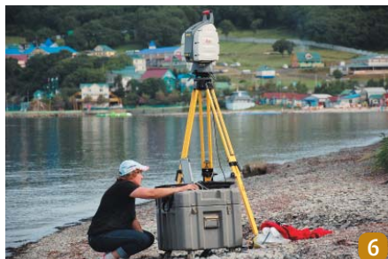
5) Система мобильного лазерного сканирования Торсон IP-S2. 6) Выполнение комплекса геодезических работ по наблюдению за деформациями прибрежной полосы в заливе Петра Великого на Дальнем Востоке. 7) Выполнение работ по обследованию геодезических пунктов методом RTK
