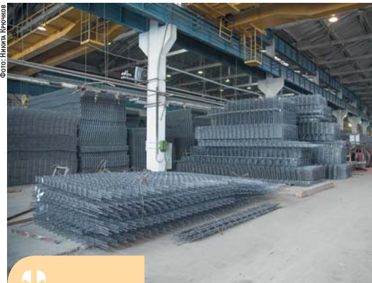
Строительные сетки из арматуры класса В500 обладают улучшенными техническими характеристиками
