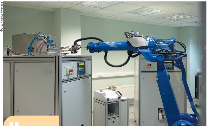
Инженеры-технологи в непрерывном режиме отслеживают качество сырья, клинкера и готового цемента с помощью уникального роботизированного оборудования
