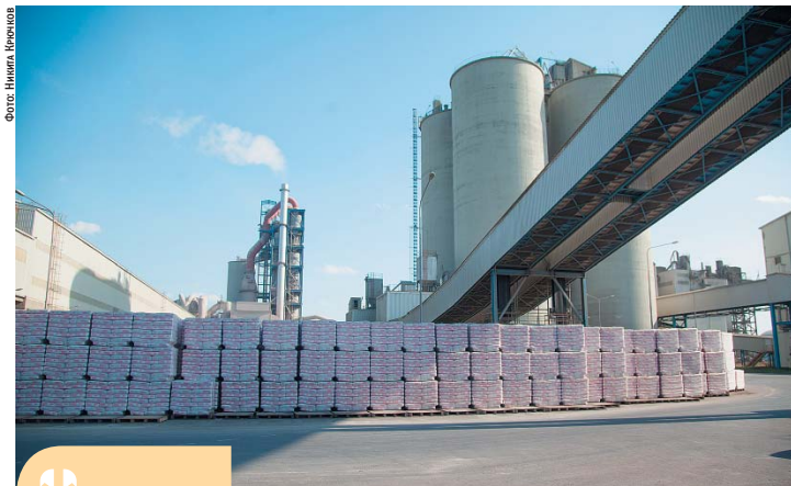
Цемент тарируется в мешки весом по 25 и 50 кг и палетируется в полностью герметичную пленочную упаковку, что позволяет хранить его на открытом воздухе
