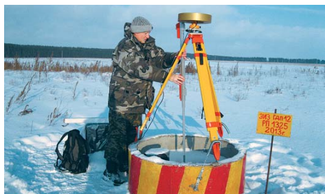
Специалисты Санкт-Петербургского научно-исследовательского изыскательского института «Энергоизыскания» выполняют геодезический мониторинг современного движения земной коры на геодинамических полигонах различных АЭС
