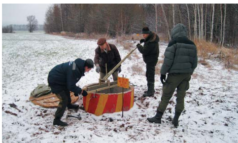
Специалисты Санкт-Петербургского научно-исследовательского изыскательского института «Энергоизыскания» выполняют геодезический мониторинг современного движения земной коры на геодинамических полигонах различных АЭС
