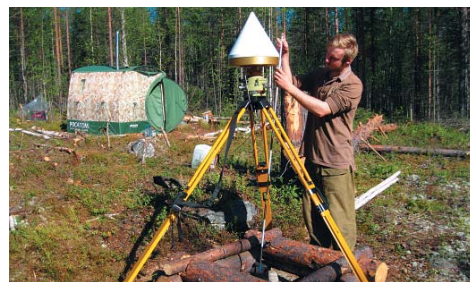
Специалисты Санкт-Петербургского научно-исследовательского изыскательского института «Энергоизыскания» выполняют геодезический мониторинг современного движения земной коры на геодинамических полигонах различных АЭС
