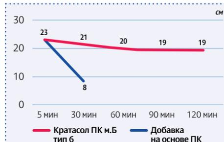
Рис. 3. Кинетика изменения осадки конуса бетонной смеси на основе поликарбоксилатной добавки (распространенной на рынке РФ) и «Кратасол ПК» марка Б. Бетонная смесь получена на основе цемента ЦЕМ I 42,5 Н («Азия Цемент»), мелкого песка (модуль крупности — 1,1), гранитного щебня (фракция — 5–20 мм). Температура бетонной смеси во время проведения испытаний — 26–28 °С
